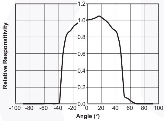
Fig. 3 Normalized Reception Pattern for the ALS Detector
